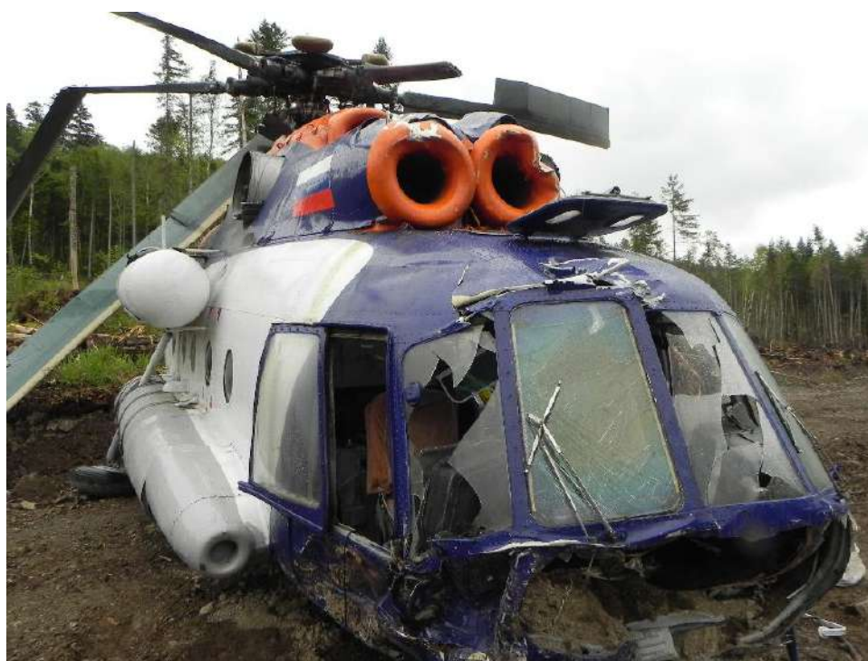
Рис. 2. Повреждения носовой части фюзеляжа
